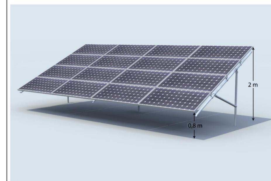
Figure 17 : Schéma de l'agencement des tables d'assemblage.
